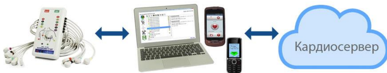
Рисунок 3.1 – Схема передачи ЭКГ
