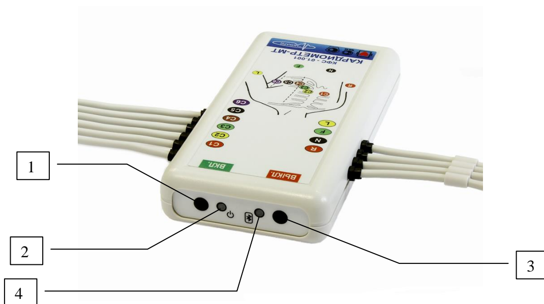
Рисунок 1.3 – УСИ. Вид сверху: 1 – кнопка включения питания; 2 – индикатор включения питания; 3 – кнопка выключения питания; 4 – индикатор наличия связи по Bluetooth
